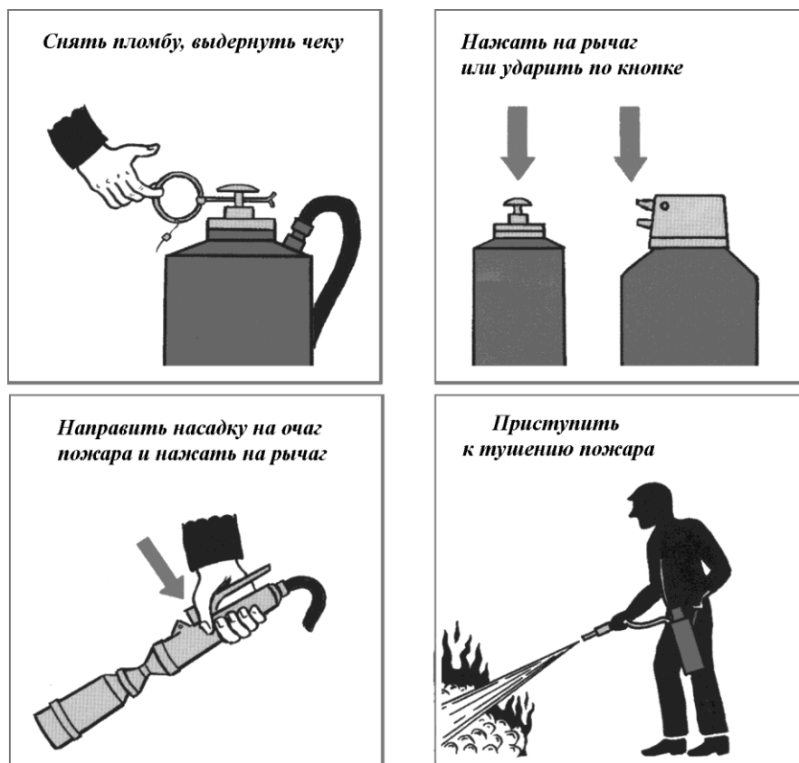
Рис. 9. Приведение в действие воздушно-пенного огнетушителя (плакат)
