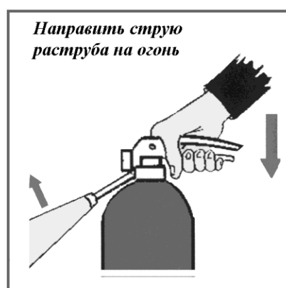
Рис. 8. Приведение в действие ручного углекислотного огнетушителя (плакат)
