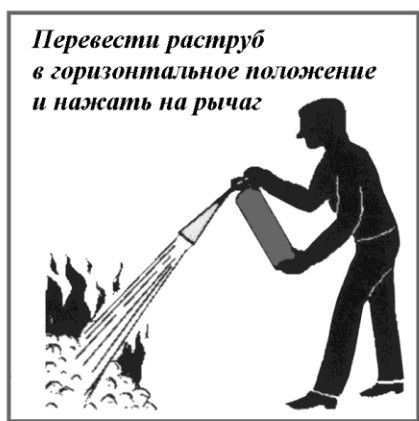
Рис. 8. Приведение в действие ручного углекислотного огнетушителя (плакат)
