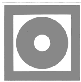
Кнопка включения установок (систем) пожарной автоматики
