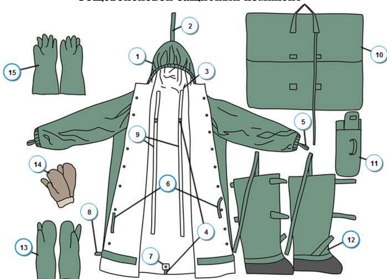
Рис. 44 - Общевойсковой защитный комплект. Источник: Сайт ОАО "Сорбент" ( www.sorben.ru ).
