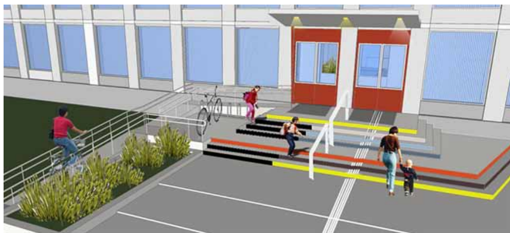
Рис. 7. Входная группа выделяется на фасаде здания за счет контрастного окрашивания и оборудована необходимым освещением
