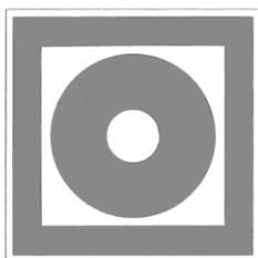
Кнопка включения установок (систем) пожарной автоматики
