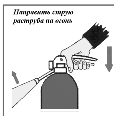
Рис. 8. Приведение в действие ручного углекислотного огнетушителя (плакат)
